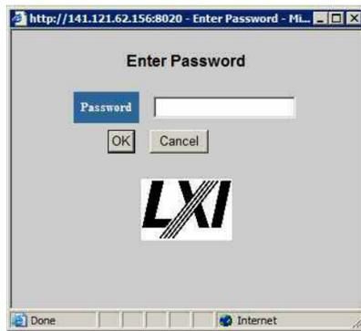
기본적으로 이 암호는 제품 출하시 'agilent'로 설정되어 있습니다. 그러나 사용자가 암호를 변경할 수 있습니다. (암호를 변경하려면 계측기 전면판에서 **System, I/O Config, Reset Web Password** 를 누릅니다.)
